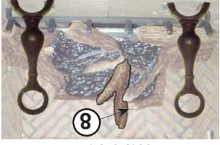
C. Placez la bûche #4 de manière à ce que le trou de positionnement au-dessous de la bûche repose sur la tige de positionnement sur le dessus de la bûche #3. L'encoche du bout opposé de la bûche #4 s'assoie sur la troisième tige du chenet à partir du côté droit.
