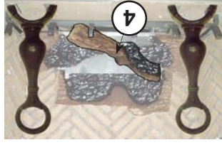
C. Placez la bûche #4 de manière à ce que le trou de positionnement au-dessous de la bûche repose sur la tige de positionnement sur le dessus de la bûche #3. L'encoche du bout opposé de la bûche #4 s'assoie sur la troisième tige du chenet à partir du côté droit.
